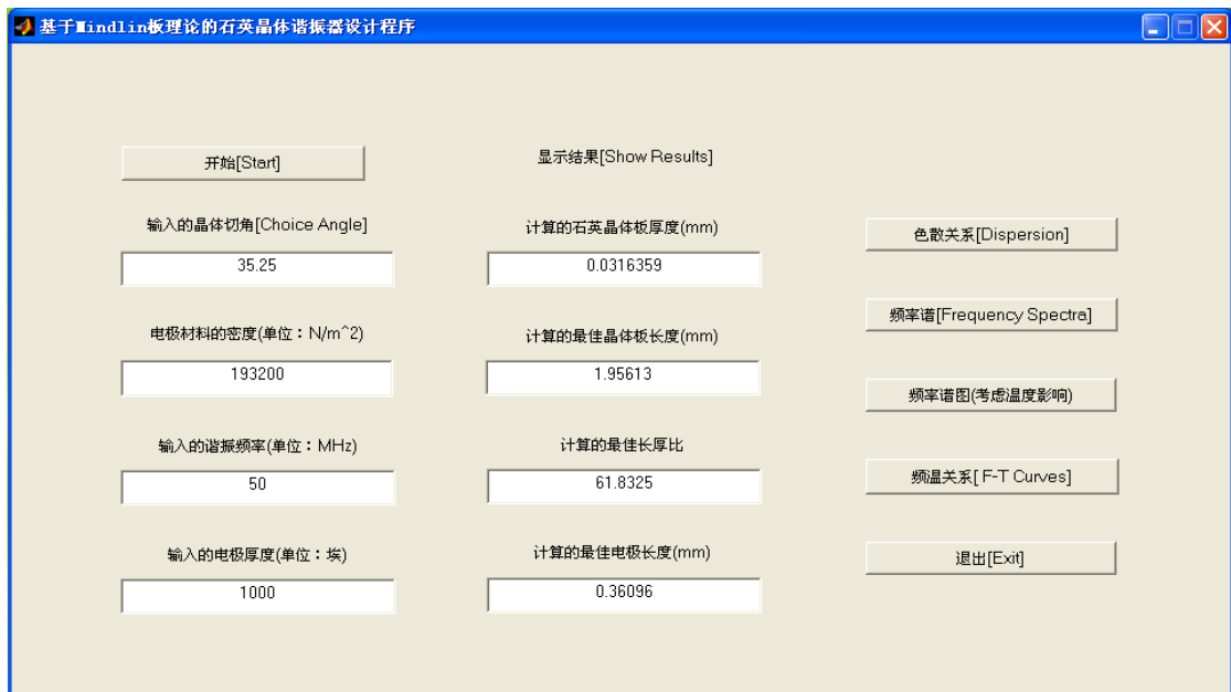
图 8. 石英晶体谐振器设计程序运行后的界面。 Fig 8. Results from quartz crystal resonator design program.
